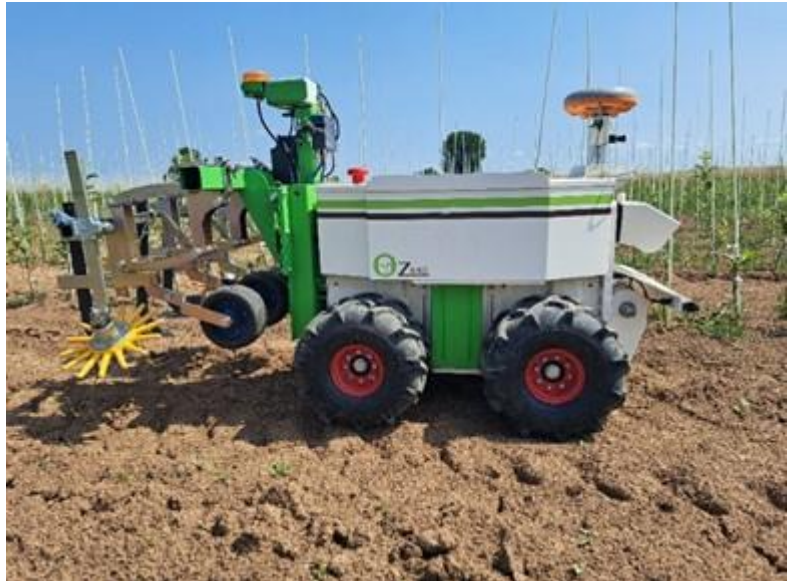
Bild 8: Der "Oz" des Herstellers Naio Technologies auf der Versuchsfläche der Obstbaumschule. Ausgestattet ist der Roboter mit drei Gänsefußscharen und zwei Fingerhacken.
