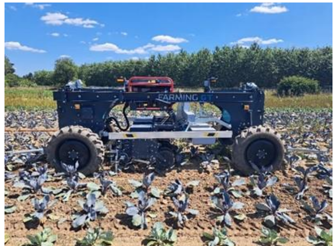
Bild 4: Autonomer Hackgang des Farming GT auf einem Praxisbetrieb in Rotkohl, Weißkohl und Wirsing
