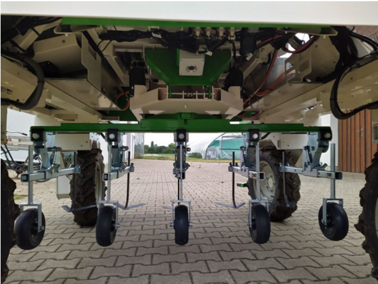
Bild 15: Fest verbauter Werkzeugträger mit einzeln abnehmbaren Parallelogrammen
