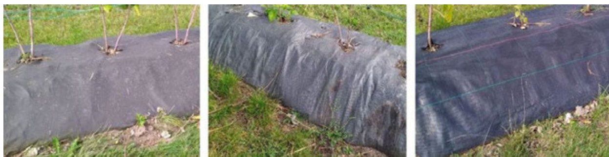
Bild 14: Die langlebigsten Varianten im Test fotografiert nach 2 Vegetationsperioden: schwarze Vlies (BioCovers), abbaubares Bändchengewebe (Ökoly) und Bändchengewebe
