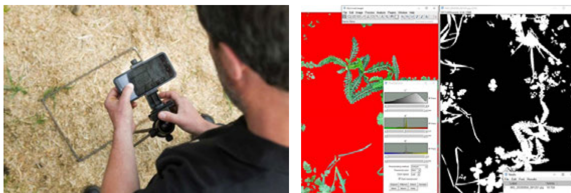
Bild 6: links: Aufnahme der Bilder für die digitale Auswertung des Grünanteils; rechts: Auswertung des Grünanteils mittels Software
