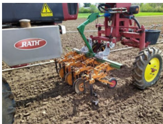
Bild 8: links: Gänsefußschare und Hackschutzrollen am Roboter; rechts: Die gleichen Werkzeuge an einem konventionellen Geräteträger
