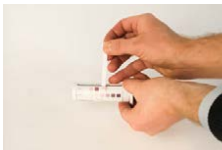
Auswerten des Teststreifens durch Vergleich mit der Skala
